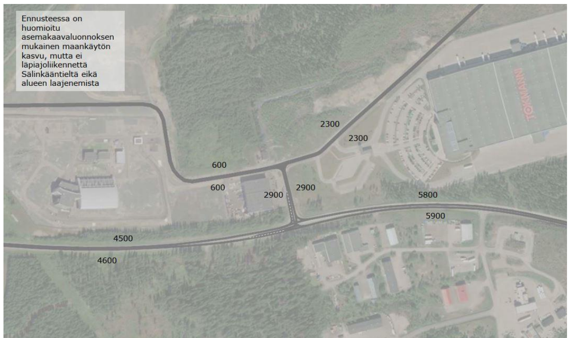
Kuva 8.2 Keskimääräinen arkivuorokausiliikenne ennustetilanteessa 2035. Isolammintietä ei ole jatkettu pohjoiseen Sälinkääntielle, eikä valtatielle ole eritasoliittymää. Kaava-alueen maankäyttö on toteutunut. Kaava-alueen länsipuolelle suunniteltua teollisuusaluetta ei ole toteutettu.
