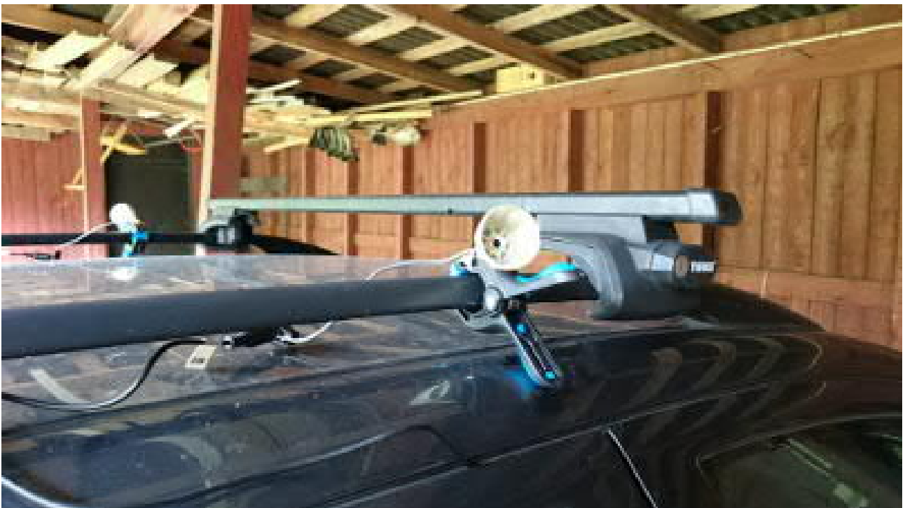
Liitekuva 1. Auton katolle sijoitetut mikrofonit tuulisuojiin. © Timo Metsänen
