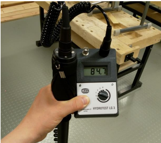
Kuva 26: Puu- ja metallityön luokissa pintakosteusluemat olivat hieman koholla välillä ~75-85.
