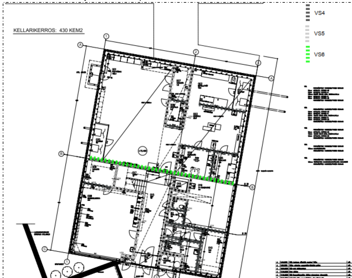
Kuva 38: Kantavat väliseinät kellarikerroksessa.
