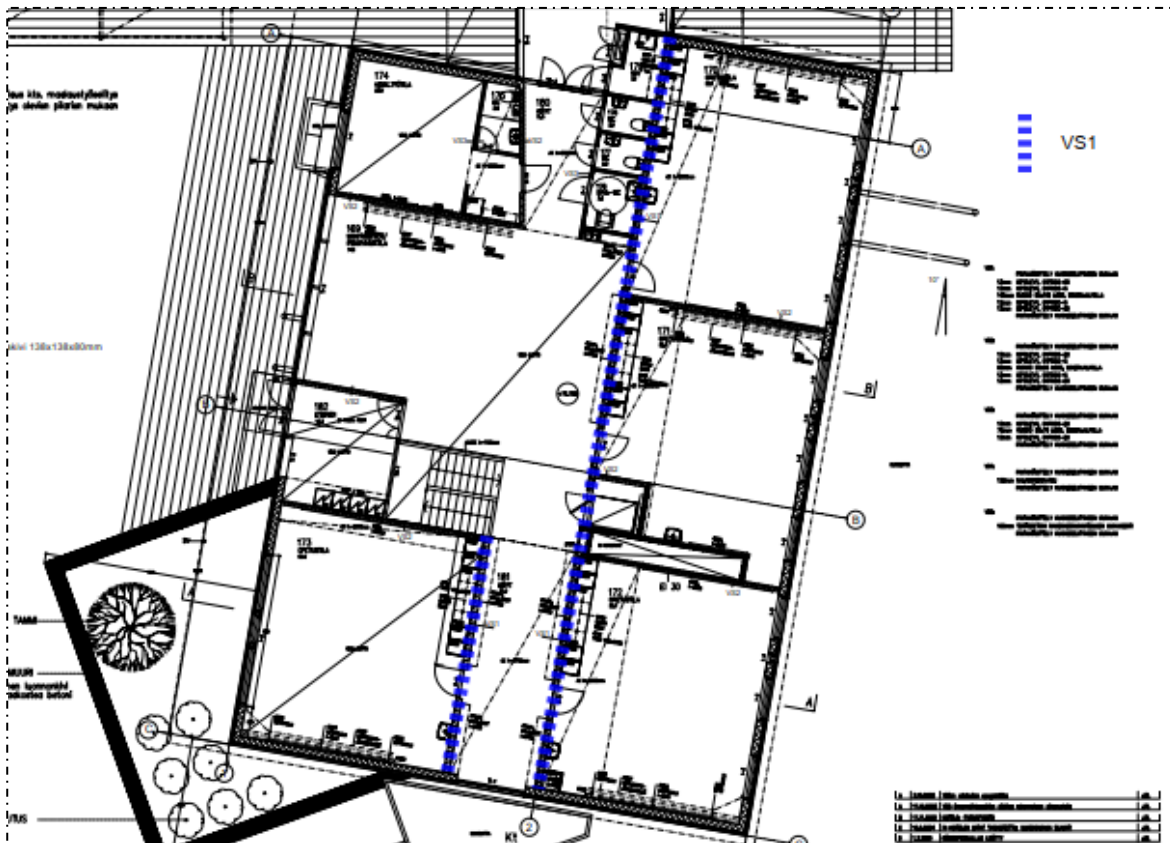
Kuva 39: Kantavat väliseinät 1. kerroksessa.
