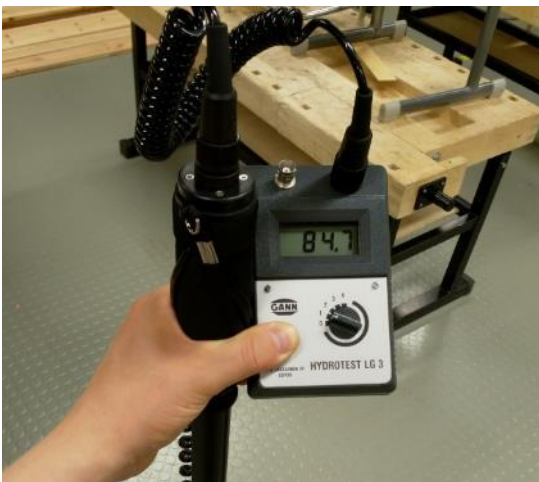
Kuva 37: Puu- ja metallityön luokissa pintakosteusluemat olivat hieman koholla välillä ~75-85.
