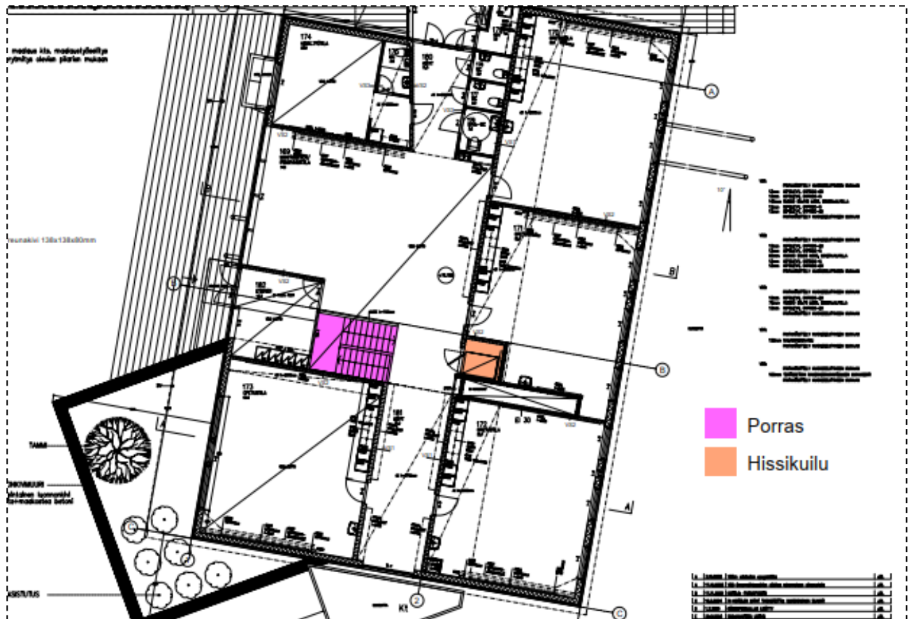
Kuva 53. Porras- ja hissikuilujen sijainnit pohjakuvasa.
