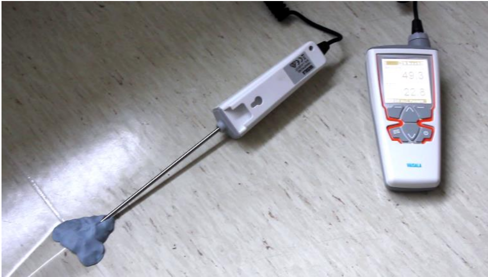
Esimerkkikuva. Viiltokosteusmittauksen toteutus.
