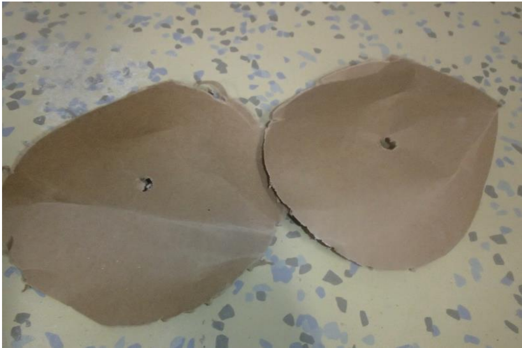
Kuva 5. Alapohjan ilmasulkupapereissa ei havaittu vaurioita.
